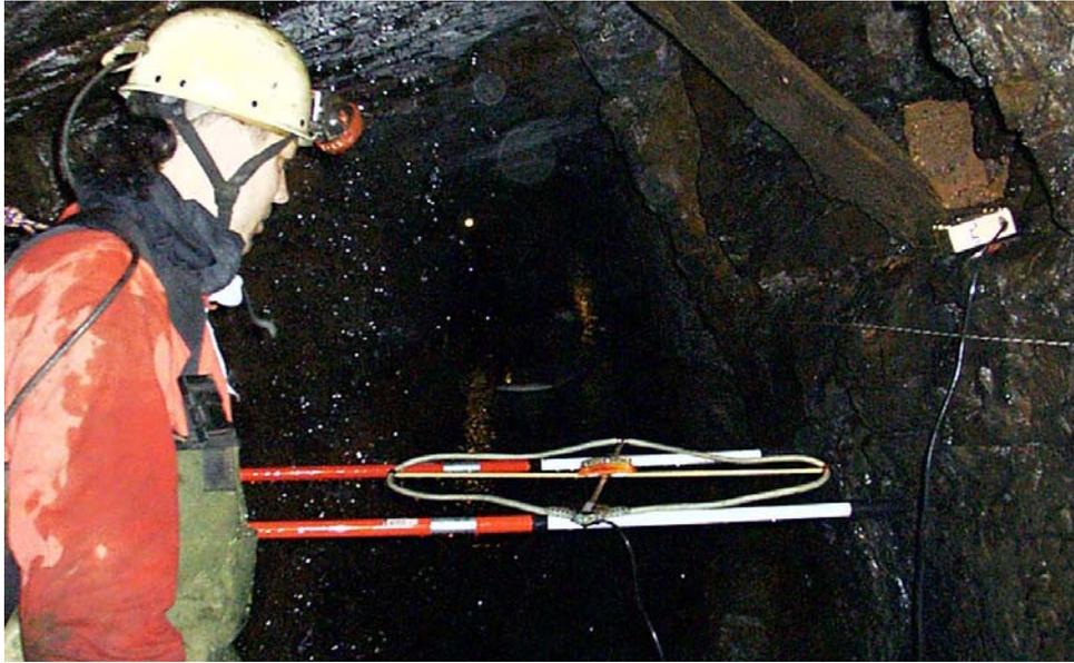
Abb. 4 Ausrichtung des Senders untertage (Foto: Karsten Malcher, GAG)
