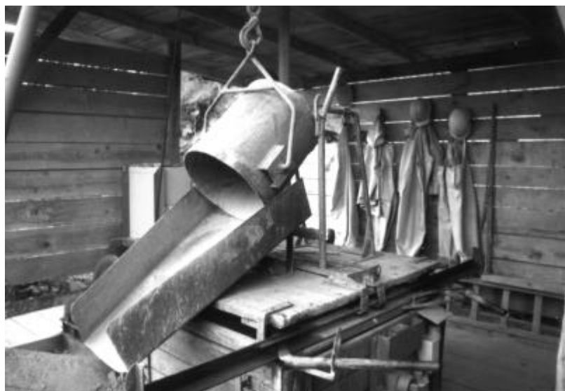
Abbildung 79: Entleeren von Förderkübeln II Kippgestell
