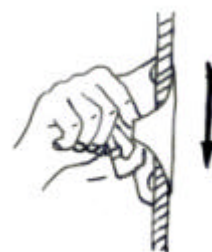
Abbildung 142: Verschieben einer Steigklemme entgegen der Klemmrichtung Nach [1]
