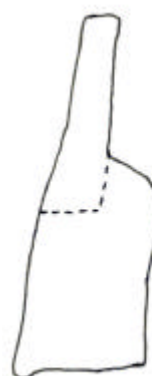
Abbildung 65: typische Profilform für einen nachgerissenen Stolln
